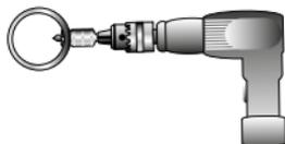
**1.** Taladre el tubo de aluminio en la posición deseada mediante una herramienta de taladrado ref. **EW09 00 30**, **EW09 00 51**, **EW09 00 64**.
