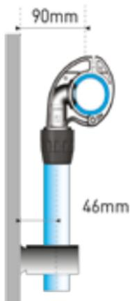
Para las bridas de derivación rápidas Transair® de Ø25 y Ø40, la distancia del centro del tubo a la pared es igual a la distancia del centro de las fijaciones a la pared, es decir, 46 mm.
