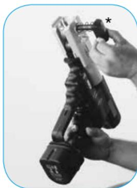
Abra el pasador de retención de la parte delantera de la máquina presionando el botón de apertura de las mordazas\*.
