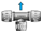
4. Deslice las tuercas de la te y coloque el cuerpo de la te entre los 2 tubos de modo que las flechas llenas y vacías estén enfrentadas.
